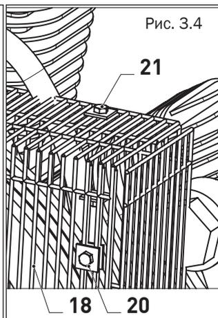
2. Открутите 4 болта (20) решетки (18) при помощи ключа гаечного 10, удалите фиксаторы решетки (21) и снимите ее.
