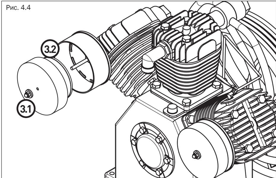
3.2 Снимите крышки фильтров вместе с фильтрами.
