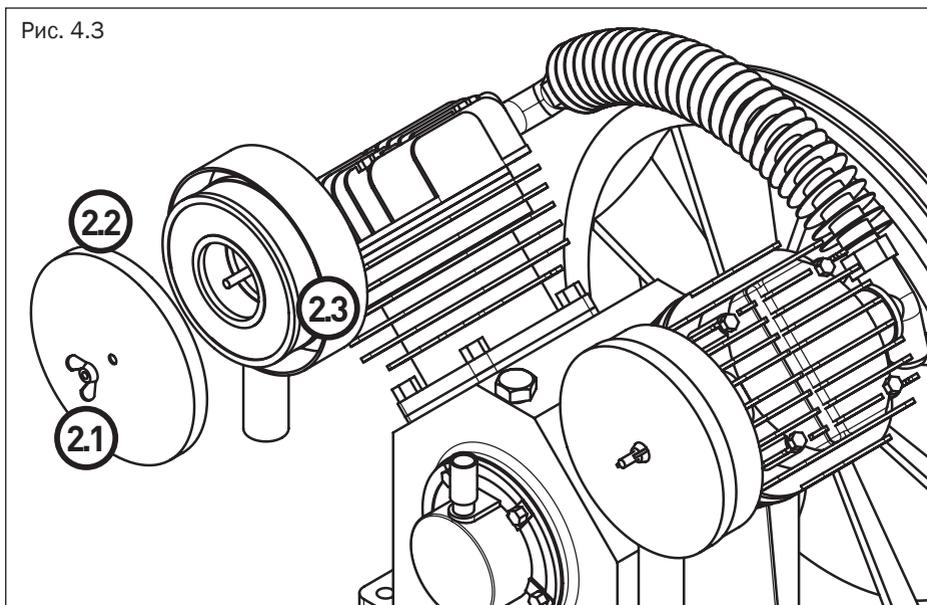
2.2 Снимите крышку фильтра. Повторите действие для других экземпляров фильтров.
