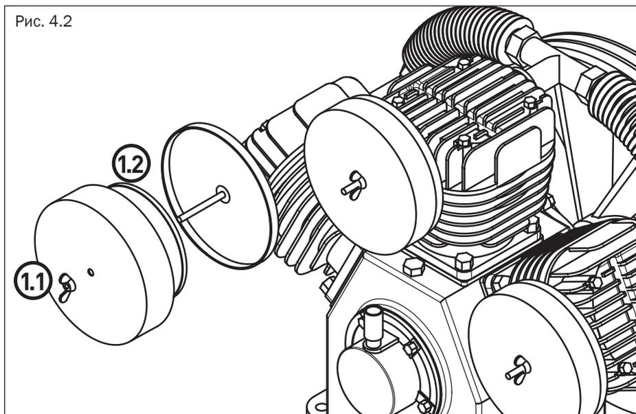
1.1 Рукой открутите гайку барашковую, удерживающую крышку фильтра, и удалите гайку. Повторите действие для других экземпляров фильтров.
