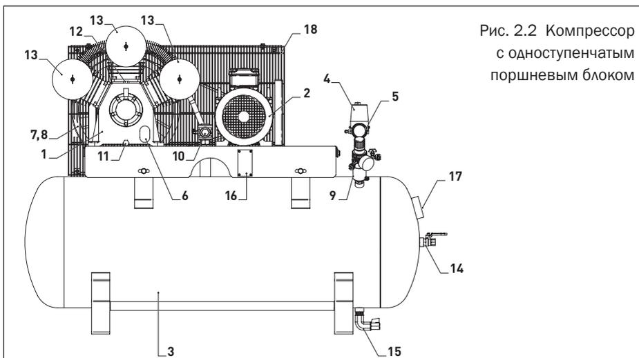
Рис. 2.2 Компрессор с одноступенчатым поршневым блоком
